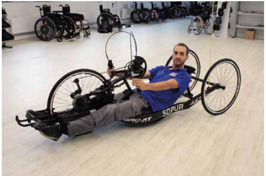
Liegerad mit Handantrieb: Geübte Handbiker erreichen mit solchen Spezialrädern Geschwindigkeiten von bis zu 40 Kilometern pro Stunde. Foto: Sebastian Heise
